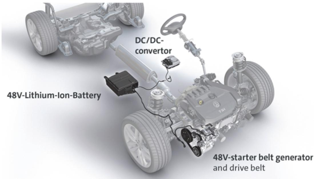
Il sistema Mild Hybrid unisce l'utilizzo del motore termico col motore elettrico, con il secondo che supporta il primo in accelerazione da fermo e nelle fasi di marcia in cui l'automobile necessita di maggiore coppia. Il motore elettrico (essendo reversibile) recupera energia in frenata (o decelerazione) che viene utilizzata in determinate fasi di marcia (ad es. in accelerazione) aiutando il motore termico fornendo potenza supplementare.
