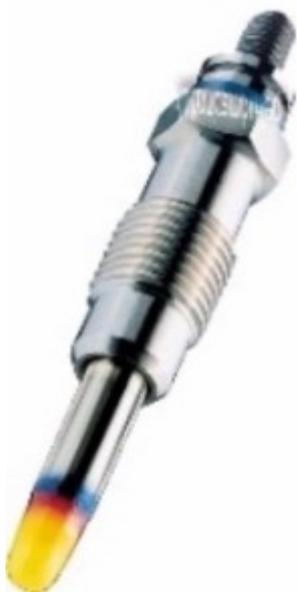
Testando le nuove candele in modo tradizionale (alimentandole con un 12 volt o facendole “sfiammare”) si rischia di danneggiarle poiché alcune di queste sono alimentate in bassa tensione a 4 volt in [pwmPulse Width Modulation](#) - Modulazione a variazione della la...
